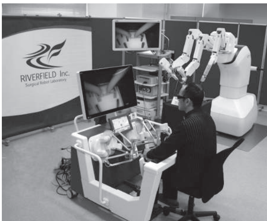
図2 開発中のマスタ・スレーブ型手術支援ロボット
